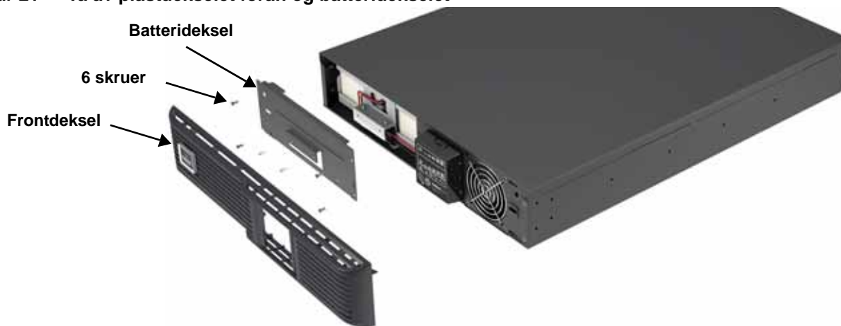
Figur 21 Ta av plastdekslet foran og batteridekselet
