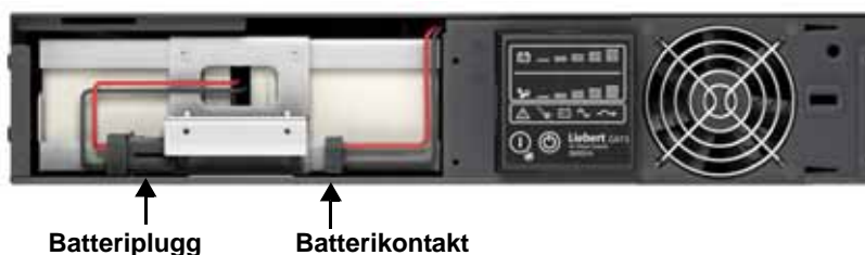
Figur 22 Koble batteripluggen fra batterikontakten (sett forfra)
